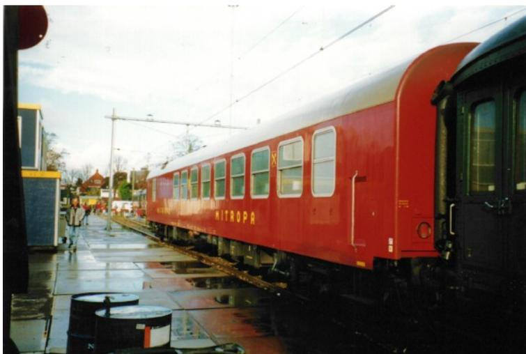
tipo Goerlitz poi Minden-Deutz, nuovi tipi di intercomunicanti, impianti di condizionamento. Queste carrozze, quelle almeno sopravvissute alla guerra, entrarono a far parte anche del parco vetture DSG. I posti a sedere nel ristorante erano distribuiti in due locali separati, il corridoio divideva, con un criterio poi largamente adottato, i tavoli a quattro posti da quelli a due. Il marchio Mitropa non ebbe quindi più spazio nel nuovo parco
